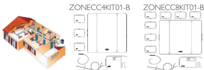
Comfort Zone II обеспечивает управление кондиционерами в 2, 4 или 8 зонах. В комплект поставки входит центральный интерфейс, контроллер, 3 или 7 комнатных датчиков температуры, датчик температуры в воздуховоде и датчик температуры наружного воздуха.
