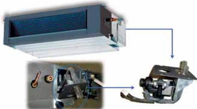
Возможна установка встроенной дренажной помпы, поднимающей конденсат на высоту до 750 мм. Это облегчает выбор места для внутреннего блока канального кондиционера
